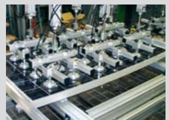
Modulbelastungstest AluTec-System©TÜV Rheinland, Deutschland
