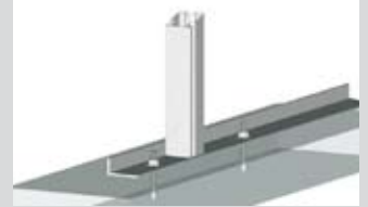
Tragfähige Oberflächen: Befestigung mit Schlagankern in Betonsteinen
