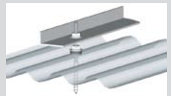
Wellfaserzement-Dach: Befestigung mit Stock- schrauben
