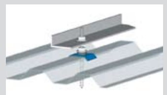
Trapezblech-Dach: Befestigung mit Stockschrauben
